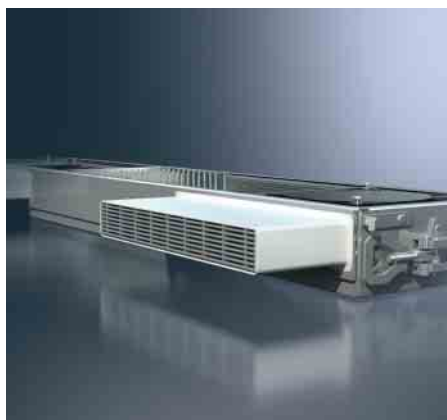
Schüco VentoTherm ist mit einem Außenluftfilter der Klasse F7 gemäß DIN EN 779 ausgestattet. Die Filterkassette kann schnell und ohne Werkzeug gewechselt werden.
