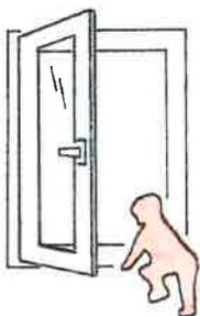
Wo Kleinkinder oder Personen mit geistiger Behinderung Zugang zum Fenster haben, ist der Flügel gegen Aufdrehen zu sichern, z.B. mit Dreh Sperre oder abschließbarem Bedienunggriff.
