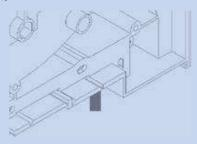
Befestigungsstiele am Kopfstück mit Schrauben X578 (3.5 x 19 mm) anschrauben.
