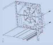
Rollladenkasten bündig am Fenster ansetzen und Stiele seitlich am Blendrahmen mit Schrauben bis in die Blendrahmenarmierung befestigen.
